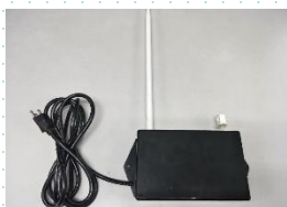
กล่องรับสัญญาณของระบบรั้วอิเล็กทรอนิกส์
